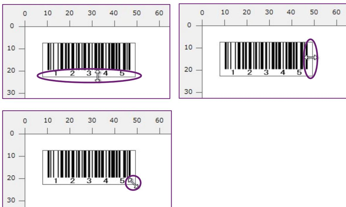
配置した [バーコードフィールド] を右クリックして [プロパティ] を選択すると、プロパティ設定画面を表示します。各種項目に入力して [OK] をクリックします。
