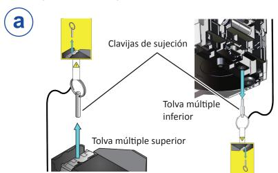
Guarde las clavijas de sujeción después de retirarlas de la tolva múltiple. Las necesitará si tiene que volver a embalar y devolver la tolva múltiple al servicio técnico.
