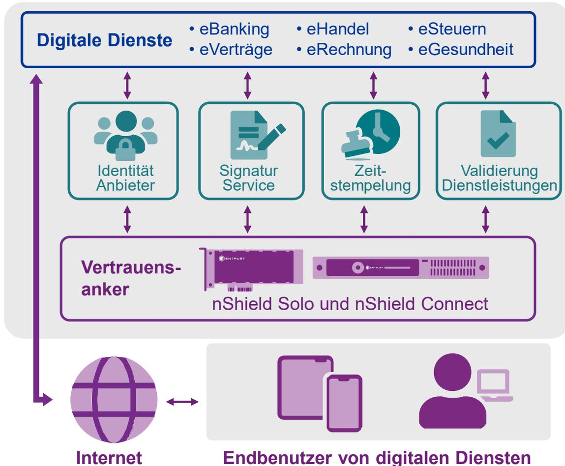
Mit nShield Hardware-Sicherheitsmodulen (HSMs) können Sie Ihre Verschlüsselungs- und Signaturschlüssel generieren, verwalten und gleichzeitig in zertifizierter, manipulationssicherer Hardware schützen.
